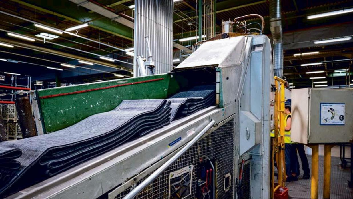
Dans l'atelier de préparation, les bandes de gomme sont transformées pour répondre aux besoins de la machine de fabrication C3M.
